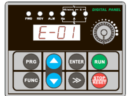
Отображение ошибки "Перегрузка по току при ускорении"
